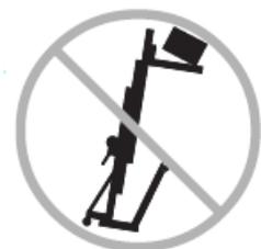
Il est interdit de déplacer la machine avec une charge en hauteur sauf pour un positionnement mineur.
